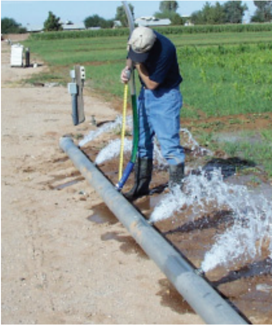
Figura 8. Estas dos fotos muestran cómo medir la carga (ft) en un sistema de tubería de compuertas. La carga es la distancia entre el nivel del agua en el tubo y el centro de la tubería. Estas son compuertas Rite-Flow™ y aquí se mide una carga de 3 pies. De acuerdo a la Tabla 8, el caudal es de aproximadamente 39 gpm por compuerta.
