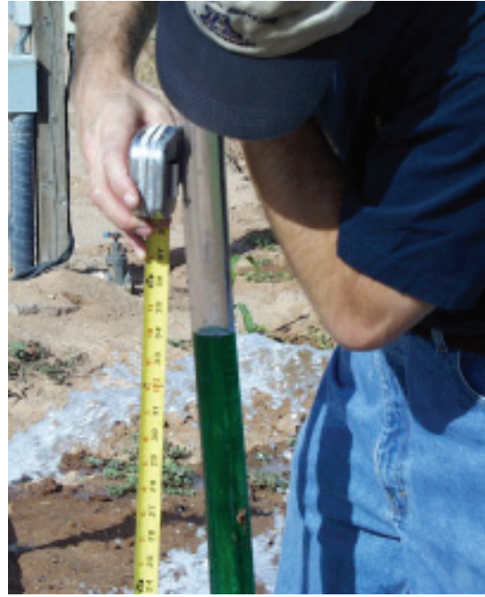
Figura 8. Estas dos fotos muestran cómo medir la carga (ft) en un sistema de tubería de compuertas. La carga es la distancia entre el nivel del agua en el tubo y el centro de la tubería. Estas son compuertas Rite-Flow™ y aquí se mide una carga de 3 pies. De acuerdo a la Tabla 8, el caudal es de aproximadamente 39 gpm por compuerta.
