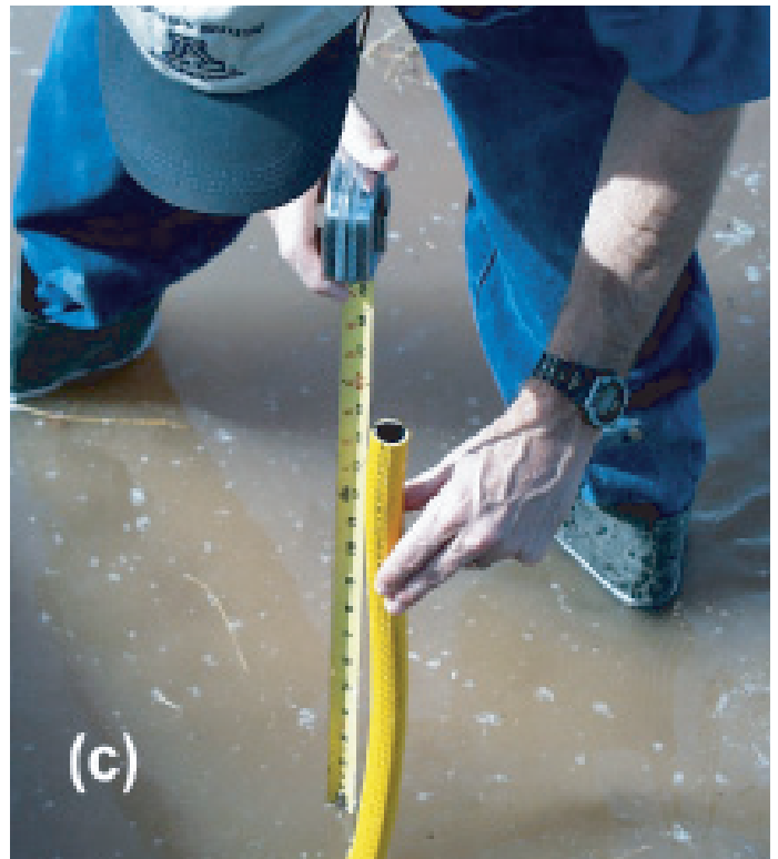
Figura 6. Tres fotos en donde se muestra cómo medir “la caída” en un sistema abierto. La caída es la distancia desde el nivel del agua en el canal hasta el nivel del agua en el campo. (a) Use la manguera para sifonear agua desde el canal; (b) Levante la manguera hasta que el agua deje de fluir y salir por la boca de la manguera; (c) Mida la distancia entre el extremo de la manguera y el nivel del agua en el campo.
